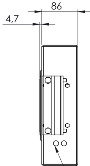
Anschlußklemme für Kabel bis 4qmm wiring terminal up to diameter AWG 11
